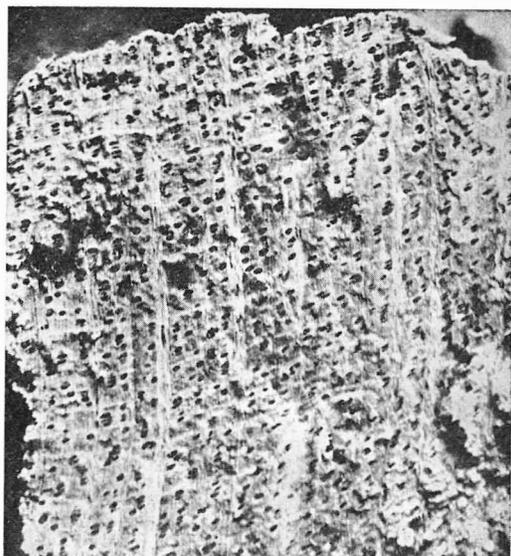
Fig. 18 - *Acer cf. pseudoplatanus*: superficie trasversale di frattura del carbone (30 x).
